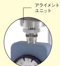
前後左右自在に可動するため、デユロメータ加圧面と試料測定面との高い密着性を実現します。GX-02、GS-610II、GS-612、GS-615に搭載。詳しくは最寄りの営業所までお問い合わせください。
